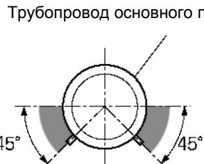
Источник давления расположен снизу от трубопровода основного процесса
