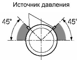
Источник давления расположен сверху от трубопровода основного процесса
