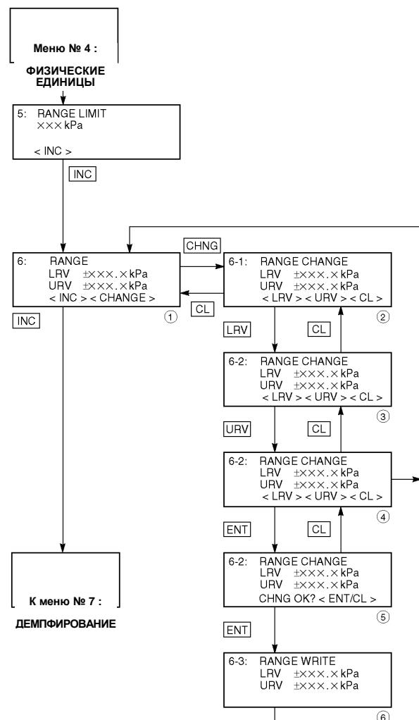
В случае шкалы с прилагаемым цифровым индикатором при изменении диапазона, показания индикатора не соответствуют. Таким образом, необходима повторная настройка экрана цифрового индикатора (G: XMTR DISPLAY). В случае шкалы с прилагаемым аналоговым индикатором при изменении диапазона, показания индикатора не соответствуют. Таким образом, требуется замена аналогового индикатора.
