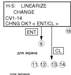
При нажатии кнопки ENT при индикации 0, отображается следующее:
