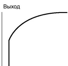
Рис. В: С нулевым выходом в режиме нижней отсечки
