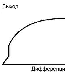
Рис. А: С линейным выходом в режиме нижней отсечки
