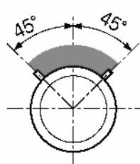
Источник давления расположен сверху от трубопровода основного процесса
