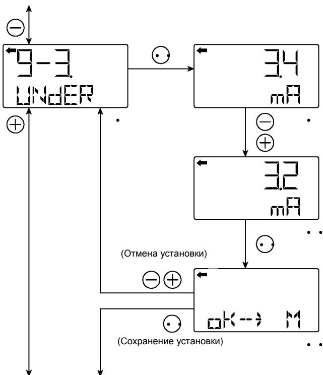
Измените ток неисправности при выборе UNDERSCALE в качестве направления.
