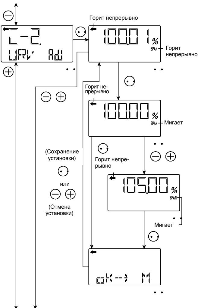
Установка диапазона шкалы изменением диапазона (URV) (Регулировка URV).
