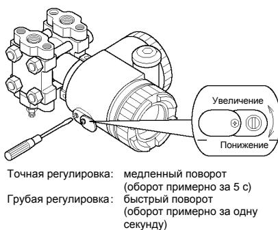
Для смещения нуля в отрицательную или положительную сторону предварительно приложите указанное входное давление и отрегулируйте выход до 4 mA с помощью внешнего винта.
