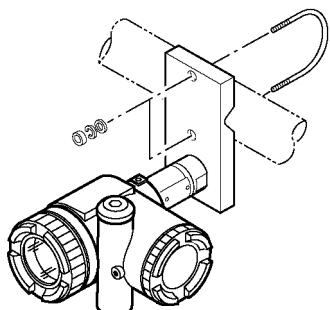
(1) Закрепите датчик на вертикальной или горизонтальной трубе с использованием прилагаемого U-образного болта (Момент затяжки примерно 15 Нм (1,5 кгсм)<11фут-фунт>).
