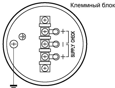
Разрядник применяется для защиты датчика или приемника от ненормального напряжения, как, например, разряды молнии, индуцированные в сигнальных линиях. Встроенный разрядник размещается за клеммным блоком.
