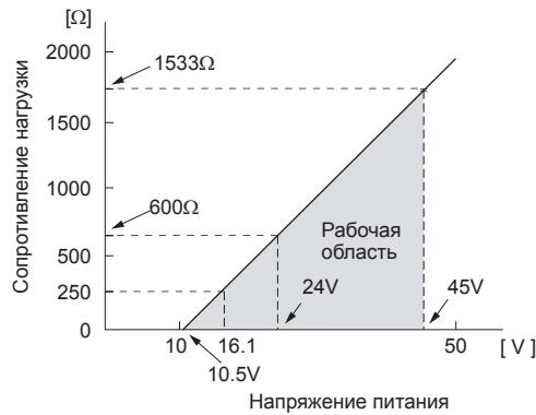
Примечание: Для подключения переносного коммуникатора FXW, требуется сопротивление 250Ω.
